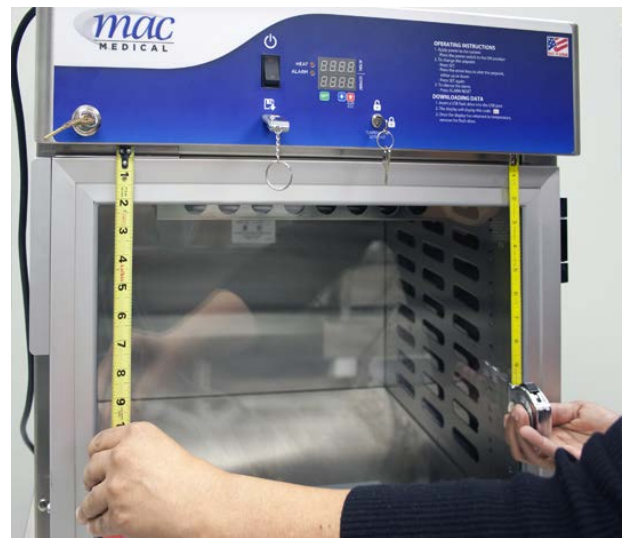
Fig. 56: Check Alignment - Square Door
