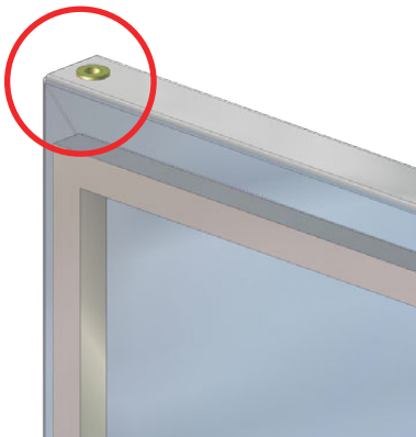
Fig. 66: Door Hinge Socket
