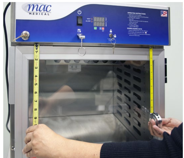
Fig. 56: Check Alignment - Square Door
