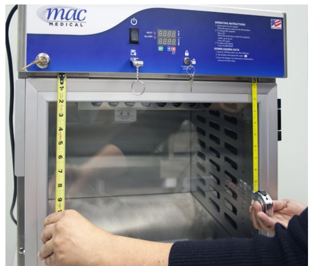
Fig. 56: Check Alignment - Square Door
